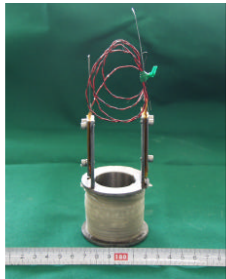
図 2 MgB_2 超伝導線材を用いた小型マグネット
