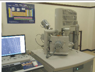
低真空電界放射型走査型電子顕微鏡 (SEM 部) FEI 製 Quanta250 FEG (EDX 部) Oxford Instruments 製 INCA Energy 250 x-act
