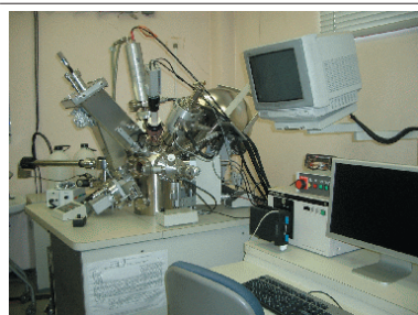
ESCA 光電子分光(XPS, UPS, AES)複合分析装置 アルバック・ファイ(株)製 Model 5600
