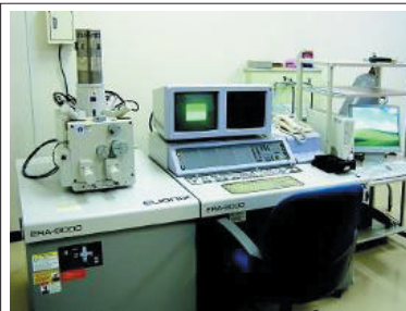
電子線三次元粗さ解析装置 (株)エリオニクス製 ERA-8000
