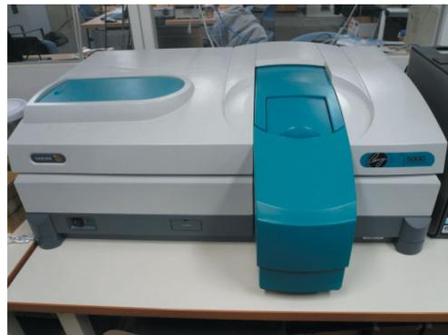
写真3 熱光学特性測定用装置
