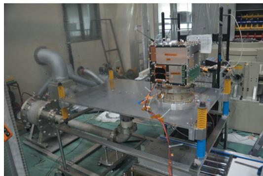
写真5 衝撃試験装置
