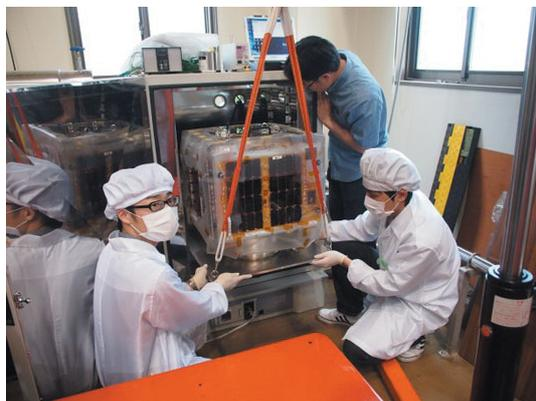
写真2 熱サイクル用恒温槽
