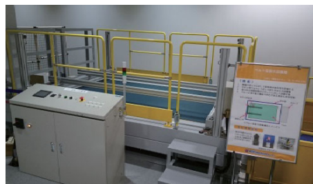
図-7 ベルト型走行耐久試験機
