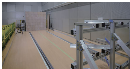
図-8 衝突安全性試験機
