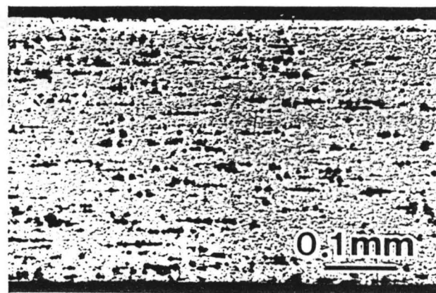
図2. 1350^{\circ}C で660%変形した試料の光学顕微鏡像
