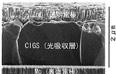
写真-1 CIGS 太陽電池の断面の SEM 写真
