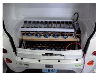
(a) ポリアニリン電池を搭載した電気自動車
