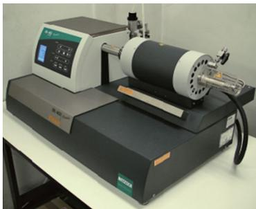
図-5 熱膨張測定装置
