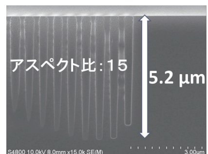
図 3 (b) i 線露光装置で作製した微細ホールパターン
