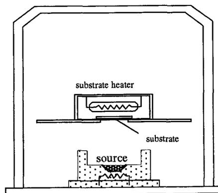
Fig. 1 deposition apparatus.
